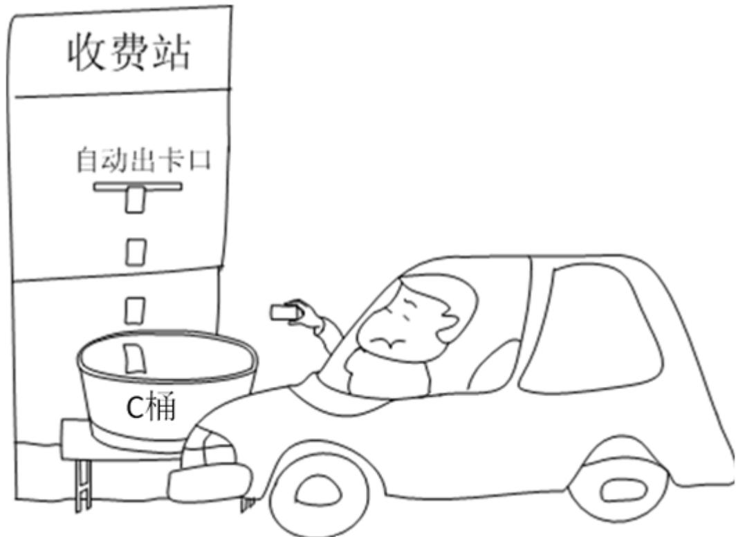
为了保持100米车距（《道路交通安全法》规定，高速公路行驶的车辆，车速超过每小时100公里时，应与同车道前车保持100米以上距离。），间隔3.6秒以上才能放行一辆车，因此出卡机每3.6秒出一个通行卡。
