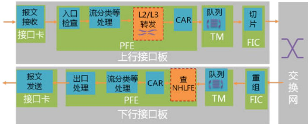
1. 上行包转发引擎PFE上解析报文，确定转发类型，此过程和普通的二层转发和三层IP转发流程的上行处理完全一致。如果是VPLS、VLL和PWE3场景，上行做的是二层转发；如果是MPLS L3VPN场景，上行做的是三层IP转发。
