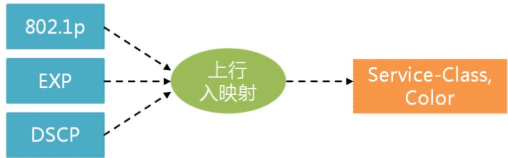
3. 根据入接口配置进行上行复杂流分类处理，即提取报文的多个信息字段进行流分类。根据分类结果执行包过滤、重标记、重定向等处理。如果是重标记（remark），则会再次重新设置内部流标记（Service-class & Color）。
