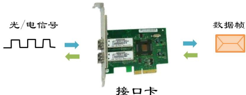
接口卡有两个重要的功能，其中一个就是完成上述的物理层功能，光/电信号的收、发；另一个重要功能，就是进行数据帧的“合法性”检查。数据经过物理线路的传递后，有可能发生畸变，变成错包，无法被包转发引擎PFE正确解析，因此在接口卡需要进行一些必要的检查。
