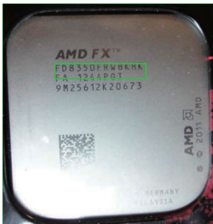
图2-21 AMD CPU参数面激光刻入的序列号
