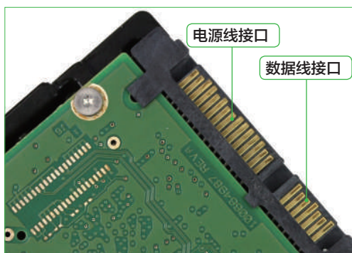
图2-98 硬盘的电源线和数据线接口
